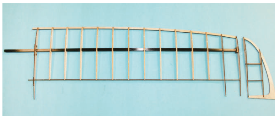
Balsa- und Sperrholzrippen sowie Kohlerohr und Kohlestab bilden das Gerüst der Tragflächen. Die Randbögen werden zum Schluss angeklebt.
